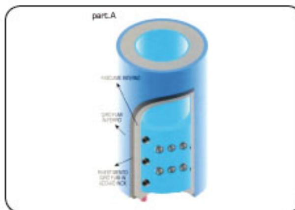
**Schema del corpo interno della caldaia
