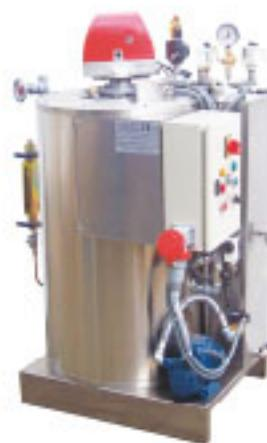
Generatore di vapore a tubi d'acqua orizzontali con potenza termica inferiore a 30.000 Kcal/h indicato per poter essere installato anche nell'ambiente di lavoro senza utilizzo di sala termica.
