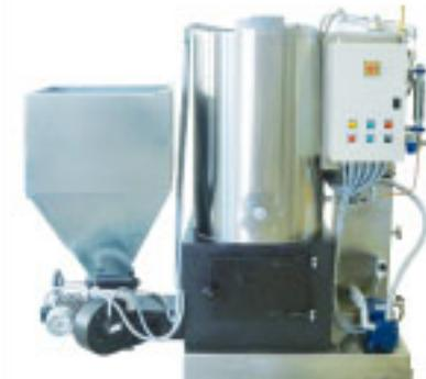
Generatore di vapore con alimentazione a biomassa. Viene fornito monoblocco completo di pedana di appoggio, vasca alimento, trasmoglia di accumulo combustibile e coccia. Può essere alimentato a pellet, noccioline o legna.
